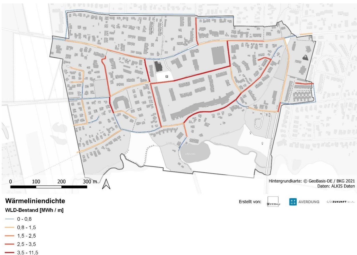
Abbildung 36: Aktuelle Wärmelinienichte im Quartier
